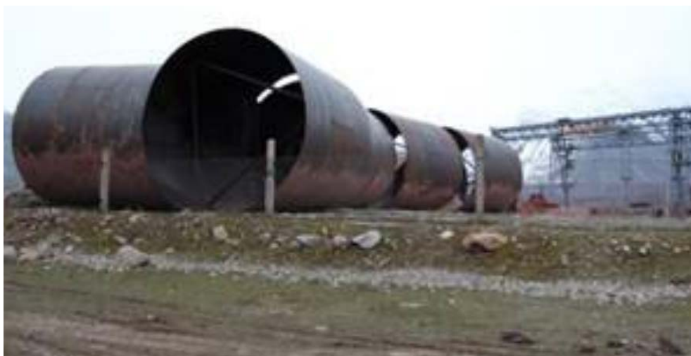
Слика 35. Допремљене цеви за вертикалан тунел довода воде до подземне хидроелектране бране "Рогун", леже у радионичком простору чекајући да буду уграђене [17].
